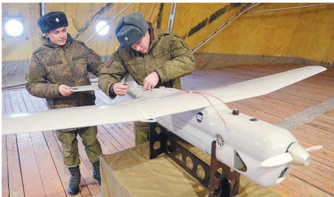
**Рисунок 7 – Российский мини-БПЛА «Орлан-10», разработанный компанией «Специальный технологический центр». Сегодня «Орланы» наиболее востребованные в РФ БПЛА своего класса**
